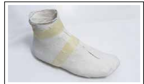
7.- Se vuelve a unir el corte realizado en el molde para que quede cerrado antes de endurecer totalmente.
